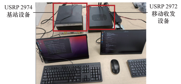
图 4 5G 仿真环境中 USRP 信号收发装置配置
